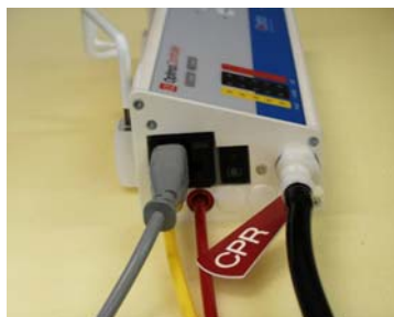
Kuva 13. CPR-letku (vain OptimaCPR-malleissa)
