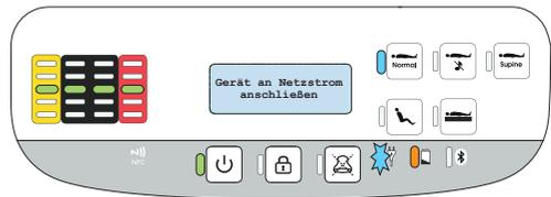
Das Gerät weist über einen einfachen Piepton auf das Anschließen an den Netzstrom hin, wenn die Funktionstasten des Geräts während des Akkubetriebs gedrückt werden.
