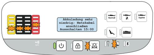
Die visuellen Signale bleiben trotz Bestätigung des Anzeigesignals bestehen und das Einstellen des Matratzensystems wird beendet, bis das Gerät wieder an das Stromnetz angeschlossen wird.
