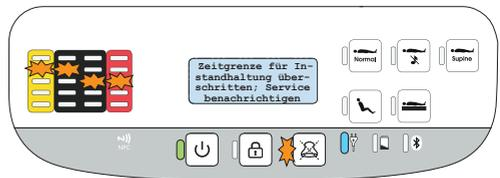
Um das Informationssignal zu quittieren, drücken Sie die Quittierungstaste für das Informationssignal. Die LED hört auf zu blinken und leuchtet konstant. Halten Sie die Quittierungstaste für das Informationssignal drei (3) Sekunden lang gedrückt, um die LED erlöschen zu lassen und das visuelle Signal aus dem Display zu entfernen.
