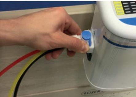
5. Verbinden Sie den Sixtube-Schnellverbinder mit der blauen Daumentaste nach oben gerichtet mit dem Steuergerät und achten Sie darauf, dass der Schnellverbinder bei der Montage einrastet.
