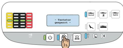
Die Tastatursperre wird auf dem Display des Geräts angezeigt. Die LED-Leuchte der Tastatursperre leuchtet auf.
