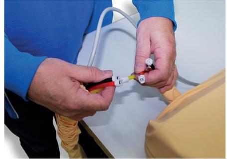
1. Trennen Sie die Liegeunterlage vom Steuergerät, indem Sie zuerst das Stromkabel abziehen. Trennen Sie dann den Sixtube-Anschluß des Luftschlauchsystems, indem Sie auf die blauen CPC-Taste drücken und das Anschlussstück herausziehen. Nehmen Sie das Stromkabel vom Stromnetz.
