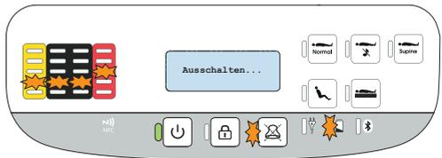
Wenn das Gerät wieder an den Netzstrom angeschlossen ist, starten Sie es neu, indem Sie die Standby-Taste drücken.
