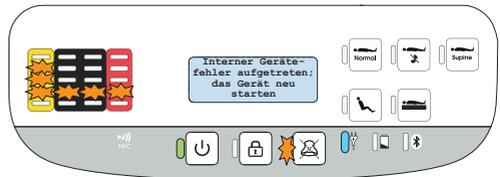
Das Anzeigesignal dieser einmaligen Funktionsstörung kann durch Drücken der Quittierungstaste des Informationssignals quittiert werden.
