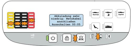
Die Anzeige für den Akkustand blinkt nach dem Versuch des Neustarts 20 Sekunden lang.
