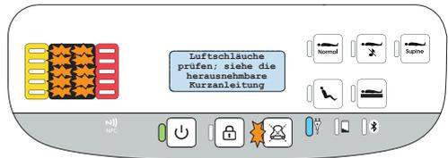
Das Informationssignal wird angezeigt, wenn das Gerät nicht innerhalb von 45 Minuten die gewünschte Betriebseinstellung erreicht. Dies kann beispielsweise an einem abgelösten Schlauch oder einem Leck in Innenluftzellen oder Schlauchsystem liegen.
