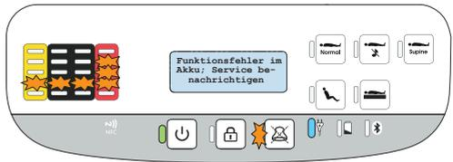
Die LED-Reihe leuchtet wie in der Abbildung gezeigt auf. Die LED für die Quittierungstaste des Informationssignals blinkt und das Display zeigt einen Funktionsfehler an.
