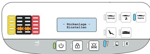
Die LED-Leuchtbalken für die Zellen fallen im Zuge der Anpassung der Zellen.
