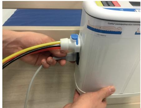
5. Conecte el cable de alimentación al conector de red del controlador.
