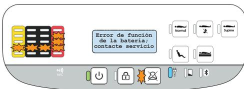
La fila de LED se iluminará como se muestra en la figura. El LED para el botón de reinicio de la señal de información parpadea y la pantalla indica un error en el funcionamiento.
