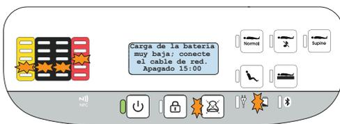
El temporizador de 15 minutos para el apagado automático del controlador comenzará a ejecutarse. El dispositivo indicará el tiempo decreciente en la pantalla.
