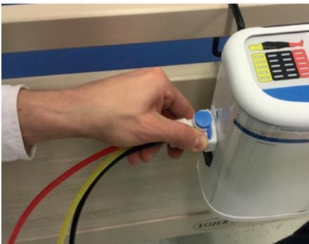
4. Conecte el conector Sixtub al controlador con el botón de liberación azul mirando hacia arriba y asegúrese de que el conector haga clic cuando se bloquee en su lugar.
