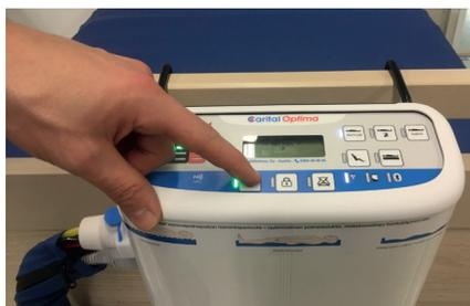
1. Presione el botón de espera para detener el dispositivo y, a continuación, desconecte el enchufe de alimentación del dispositivo de la red eléctrica.
