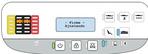
El dispositivo ha activado el funcionamiento *Firme*. El LED de funcionamiento *Firme* está encendido y los LED de la celda se encienden en la fila central.
