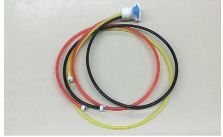
*Sistema de tubos de aire entre el controlador y las celdas, incluidos los conectores.*
