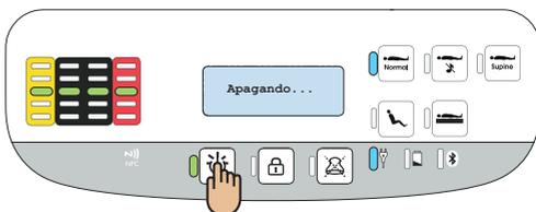
El dispositivo permanece conectado a la red eléctrica y el LED de conexión de alimentación permanecerá encendido hasta que el dispositivo se desconecte de la red eléctrica.
