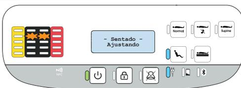
El LED de funcionamiento *Sentado* se enciende y los LED de la celda se moverán hacia arriba o hacia abajo.
