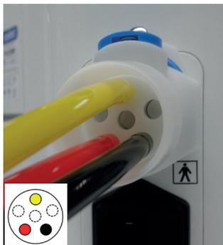
Abra la funda protectora de los tubos hasta que los conectores de los tubos se descubran: compruebe que los tubos entre las celdas y el controlador estén conectados a los conectores. Compruebe también que los colores coincidan (por ejemplo, negro con negro). Compruebe si hay fugas o algún daño claramente visible en las celdas.
