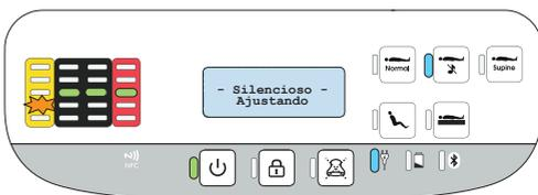
El dispositivo ha activado el funcionamiento *Silencioso*. El LED de funcionamiento está encendido y los LED de las celdas se encienden en la fila central.
