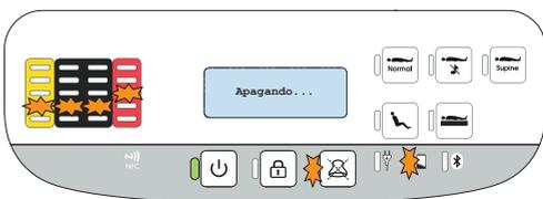
Cuando el dispositivo esté conectado de nuevo a la red eléctrica, reinicielo presionando el botón de espera.
