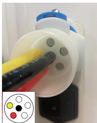
Ouvrez le raccord de tuyau jusqu'à ce que les raccords de tuyau soient visibles : vérifiez que les tuyaux entre le nid d'abeilles et le contrôleur ne sont raccordés à aucun endroit. Vérifiez également la correspondance des couleurs (par exemple, noir sur noir). Vérifiez également que le nid d'abeilles ne présente pas de dommages ou de fuites clairement visibles. Si vous trouvez des tuyaux mal fixés, raccordez-les correctement. Fermez le tuyau.
