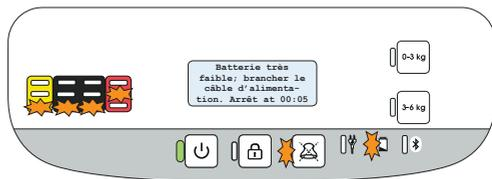
Si la tension de la batterie interne tombe à un niveau critique ( $< 7,0\text{ V}$ ), l'appareil s'éteint immédiatement et le voyant de la batterie clignote pendant 20 secondes.
