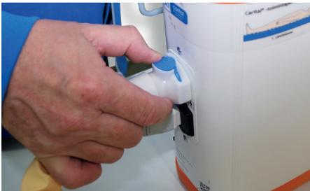
3. Retirez le connecteur Sixtub du tuyau d'air en appuyant sur le bouton bleu du CPC et en tirant le connecteur vers l'extérieur.
