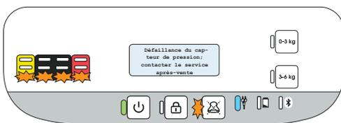
Vous pouvez acquiescer le signal d'information de défaut en appuyant sur le bouton d'acquiescement du signal d'information. Le signal d'information n'est acquiescé que pour le son, les signaux d'information visuels restent allumés et l'appareil ne revient pas à la fonction précédente.
