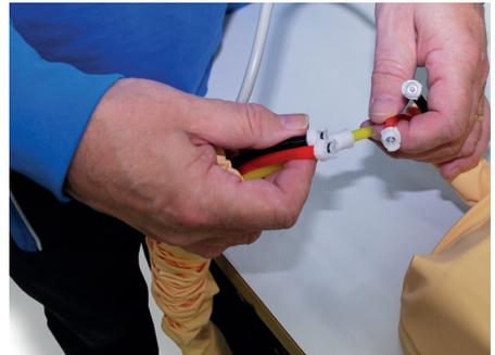
1. Déconnectez la surface de support du contrôleur en débranchant d'abord le câble d'alimentation. Débranchez ensuite le connecteur Sixtube du système de tubes à air en appuyant sur le bouton bleu du CPC et en tirant sur le connecteur. Débranchez le câble d'alimentation du secteur.
